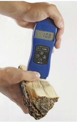
Messung des Wassergehaltes mit einem Schnellbestimmungsgerät
